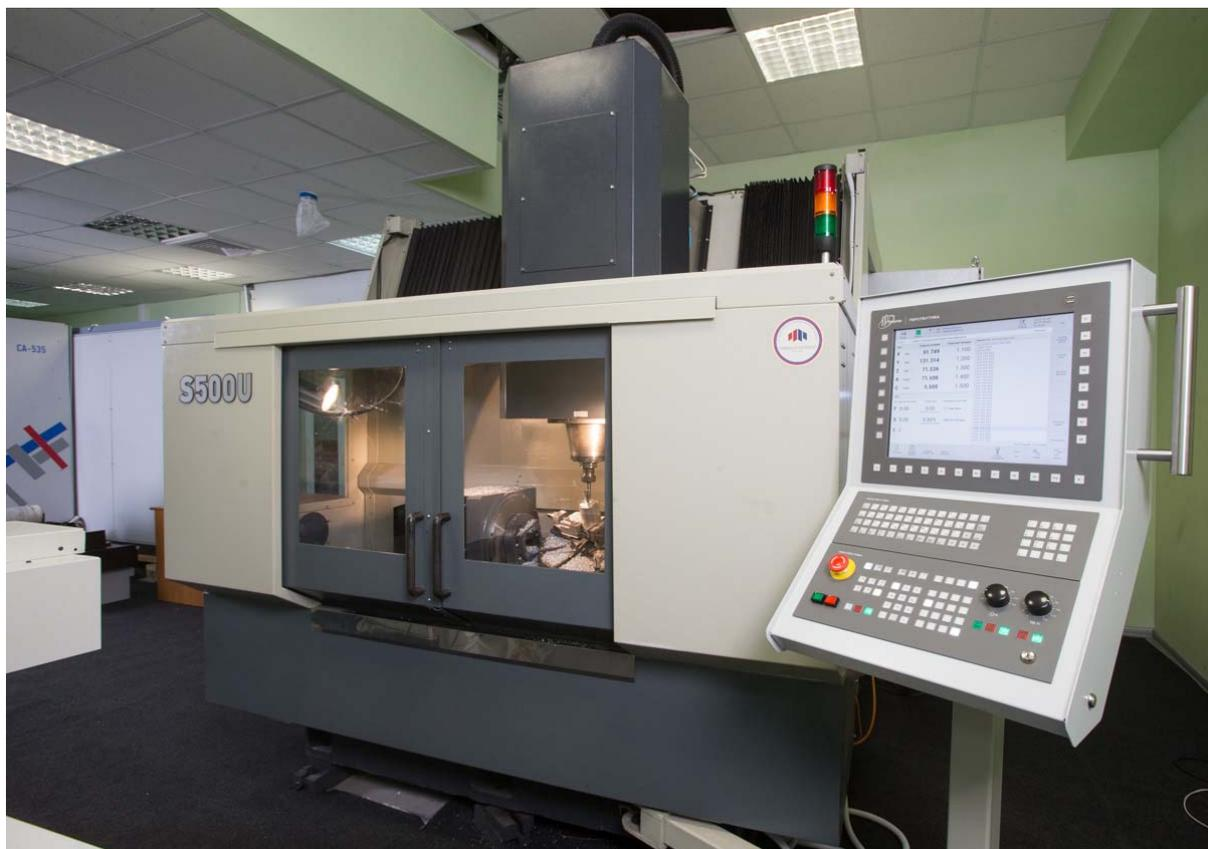
СЧПУ «Перспектива» на 5-координатном вертикально-фрезерном обрабатывающем центре производства компании НПО «Станкостроение»
