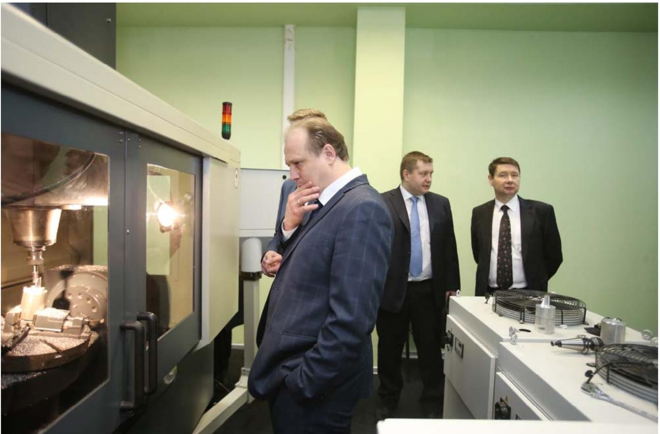
Технический директор ООО «СТАН» Звягинцев Р.В. наблюдает за процессом 5-координатной обработки лопатки на обрабатывающем центре производства компании НПО «Станкостроение», входящей в группу компаний «СТАН»
