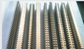
Елочные протяжки и зубрезные долбки, подвергаемые дуплексной обработке (азотирование + покрытие типа (Nb- Ti- Al- V)N)
