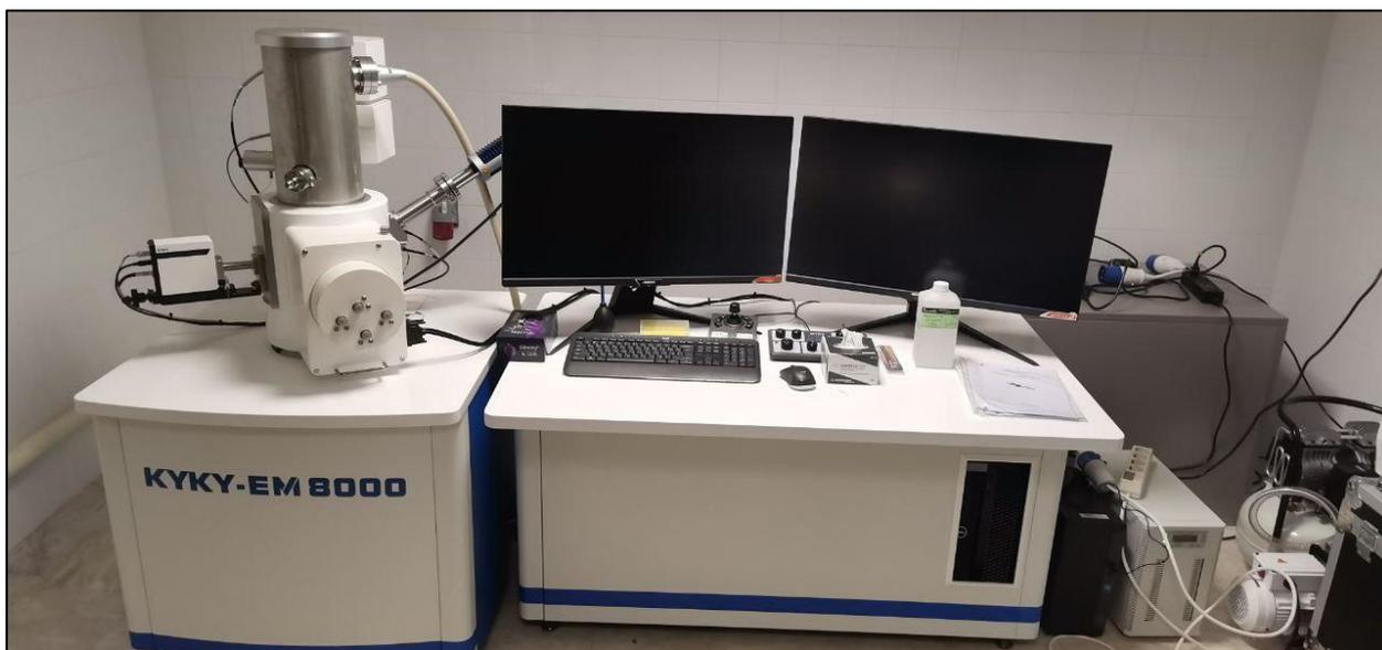
Рисунок 1. Сканирующий электронный микроскоп КУКУ-8000
