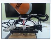
Инструмент имитации паллетирования. Оснащён пневматическим захватным устройством (вакуумные присосы).
